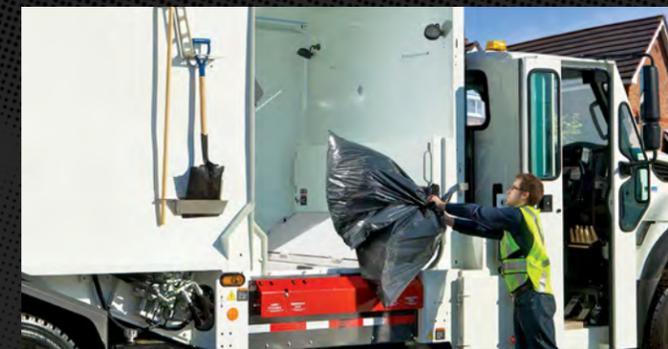
La configuration à châssis surbaissé Expert est parfaite pour la collecte manuelle ou semi-automatisée de déchets ou de recyclage, et la hauteur de chargement de seulement 5,5 pouces au-dessus du châssis rend cette configuration plus sûre, plus rapide et plus facile à charger. Avec l'empattement le plus court de l'industrie, ce camion peut facilement manœuvrer dans les espaces les plus étroits où d'autres fabricants à châssis surbaissé ne peuvent pas accéder.
